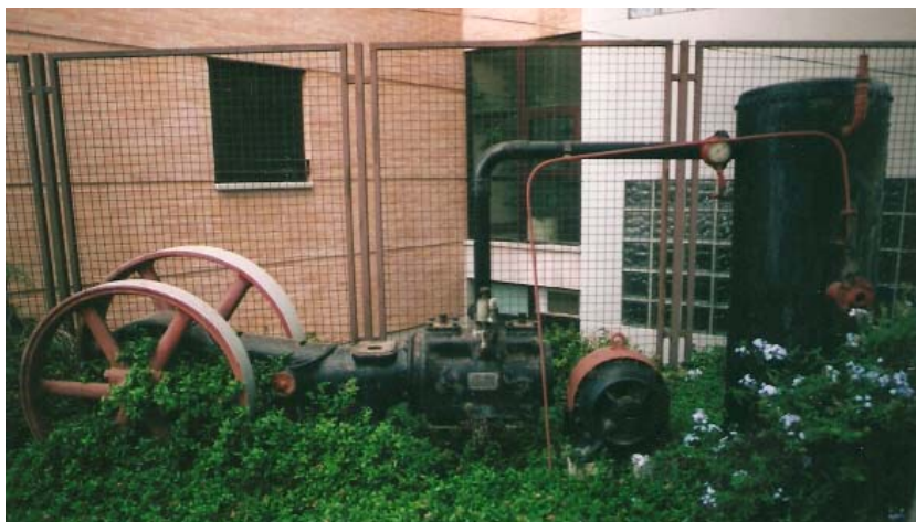
0408 – Antigua compresor de gas pobre para la extracción de agua desde el artesiano a unos 40 metros de profundidad con un total de 90 metros de taladro (6-8-2002)
