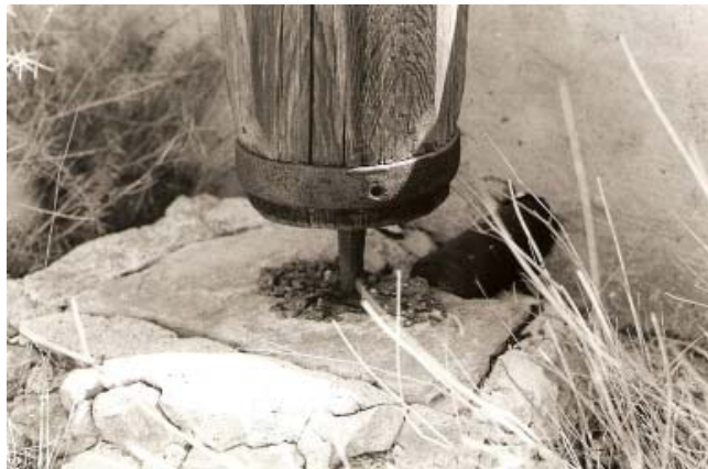
0205 – Parte inferior del eje con su ceño, y con el gorrón apoyando en la "tejuela" (15-9-1979)
