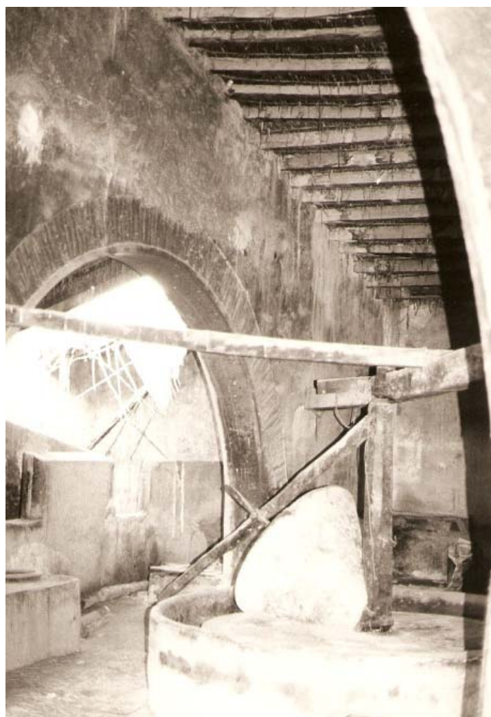
0220 – Piedras de almazara, viguería y ejes con algunas azaquefas al fondo. En Alhama ya no existen almazaras de piedras ni ha sido posible obtener fotografías antiguas de ellas. La almazara que aquí aparece corresponde al término de Torre Pacheco y ya también ha desaparecido (15-9-1979)
