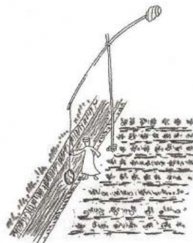
Fig.92- Esquema de Algaydonal con el que se regaban 435 tahullas en Alcantarilla.
